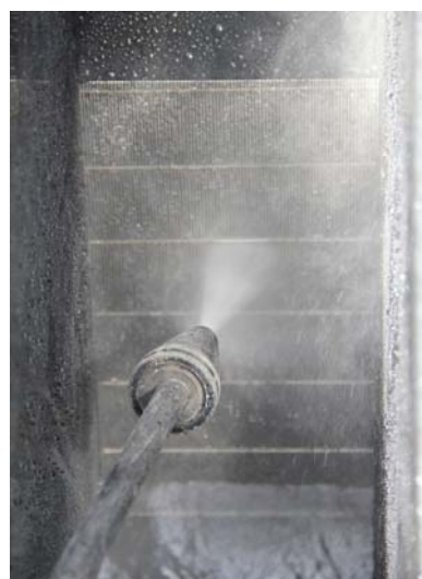
Afb. 20: Reinigen van het zeefoppervlak met een hogedrukreiniger
