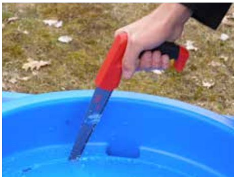
Uitsnijden van de markeringen met behulp van een handzaag
