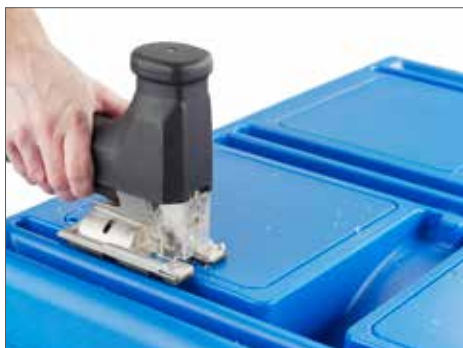
Uitsnijden van de aansluitingen op de Sikkofix Box met een decoupeerzaag
