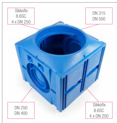
Bodemelement C3 voor een zijdelingse aansluiting (Type S)
